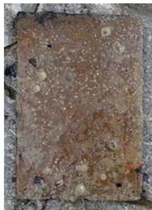
*а) контроль (диспергированная медь (I))      б) покрытие содержащее иммобилизат*
